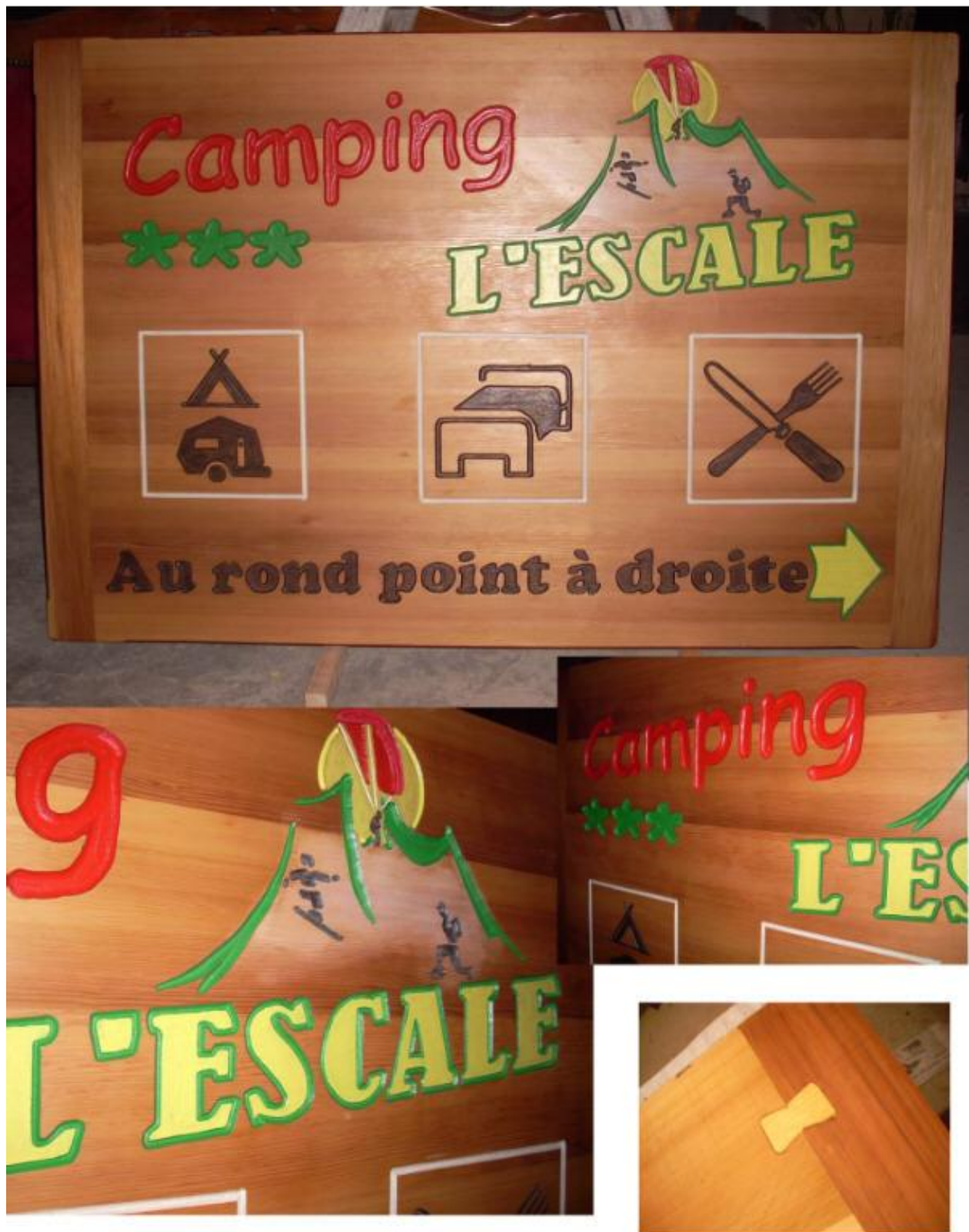
Au dos du panneau.. Inclusion en papillon de clés en bois , verrouillants ainsi l'assemblage perpendiculaire.
